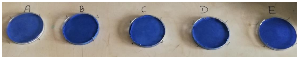
Rys. 1. Zdjęcie przygotowanych powierzchni samoczyszczących przed wystawieniem na działanie promieniowania słonecznego.
