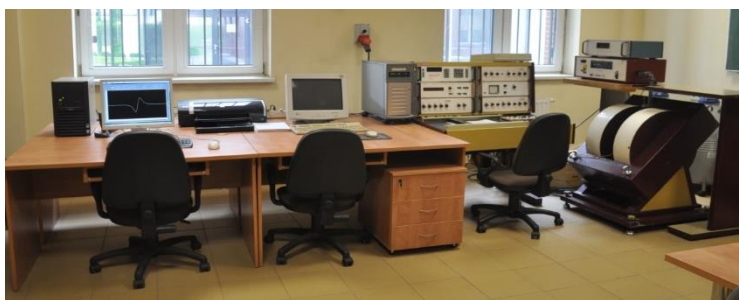
Rysunek 2. Spektrometr EPR na pasmo X firmy Radiopan. Katedra i Zakład Biofizyki w Sosnowcu [opracowanie własne]
