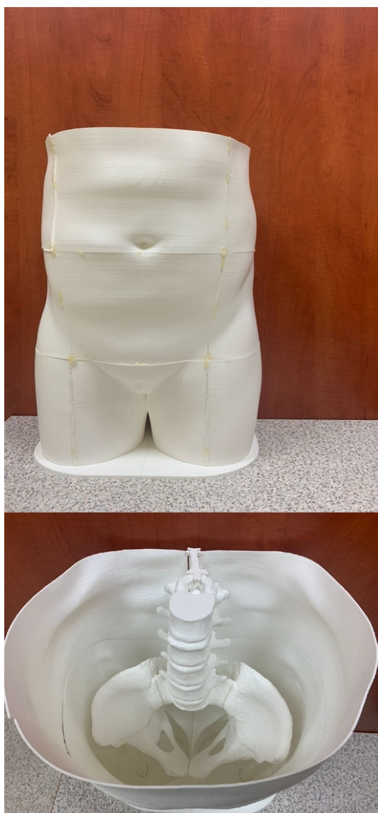
Rysunek 20. Przygotowany szkielet oraz skóra wykonana w technice druku trójwymiarowego [Materiał własny]
