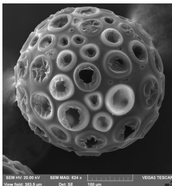
Zdjęcie 1. Obraz SEM żywicy GMA otrzymanej przy udziale toluenowej dyspersji nanocząstek Fe 3 O 4 .
