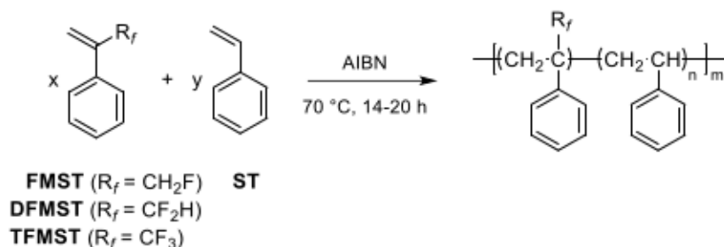
Schemat 9. Konwencjonalna kopolimeryzacja w masie \alpha -fluorometylostyrenu (FMST), \alpha -difluorometylostyrenu (DFMST) oraz \alpha -trifluorometylostyrenu (TFMST) ze styrenem (ST) inicjowana AIBN w temperaturze 70 °C [H6, H7].
